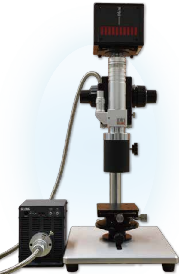
▲高速度カメラ FASTCAM Mini AX200 と SE-MP-L / SEL-LWD200 / LED 光源【煌】とのセット例
